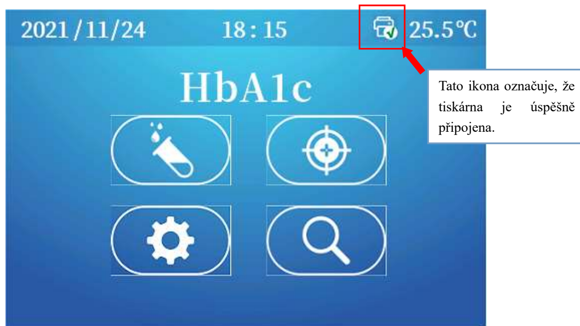
Obr. 5-6-1 Schematický diagram úspěšného připojení tiskárny
